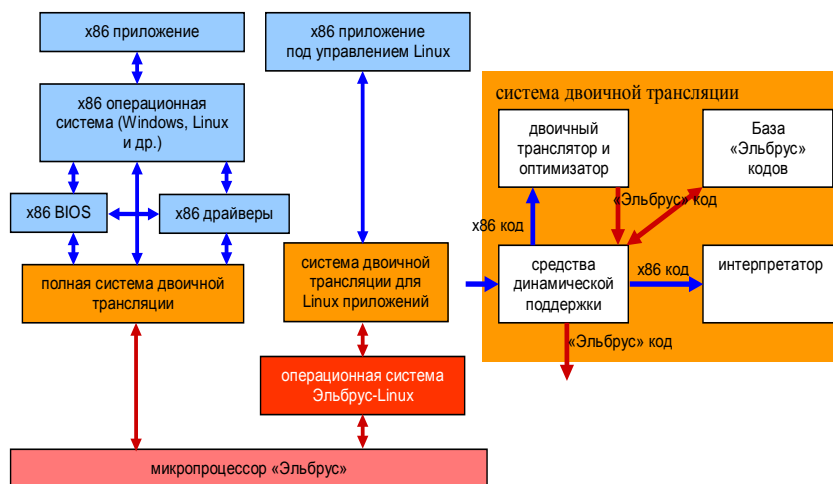
Рис. 3. Схема обеспечения совместимости с помощью технологии двоичной трансляции.
